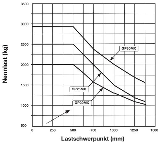
**Staplerkonfiguration:** Zweifach-Hubgerüst mit begrenztem Freihub (4.330mm maximale Gabelhöhe für GDP20-25MX und 4.105mm maximale Gabelhöhe für GDP30MX).
