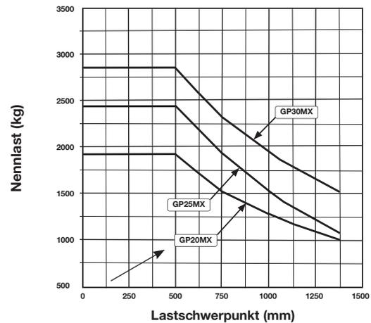
**Staplerkonfiguration:** Zweifach-Hubgerüst mit begrenztem Freihub (4.330mm maximale Gabelhöhe für GDP20-25MX und 4.105mm maximale Gabelhöhe für GDP30MX).
