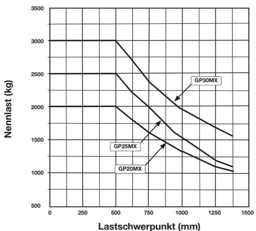
**Staplerkonfiguration:** Dreifach-Hubgerüst mit Vollfreihub bei höchstem bekannten Hochhub (maximale Gabelhöhe 4.015 mm bei GP30MX).
