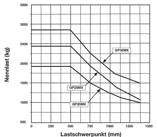
**Staplerkonfiguration:** Dreifach-Hubgerüst mit Vollfreihub bei höchstem bekannten Hochhub (maximale Gabelhöhe 4.015 mm bei GP30MX).
