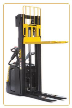
und gestattet dadurch das Fahren auf unebenem Boden, Ladeebenen und Rampen. Die Hub-/Senksteuerung erfolgt über zwei Drucktasten links an der Deichsel. Die einstellbaren Zugstangen ermöglichen eine gleichförmige Hub- und Senkbewegung der Gabelzinken. Die Lastrollen in Tandemausführung sind mit Schmierpunkten und gekapselten Lagern ausgestattet. Bei angehobenen Lastarmen wird die Geschwindigkeit automatisch reduziert.
